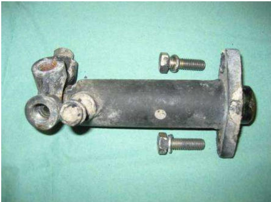
Nach Lösen der beiden Befestigungsschrauben kann der Kolben vorsichtig in axialer Richtung abgezogen werden. Dies kann aufgrund der Passung etwas schwergängig sein, aber keine Gewalt anwenden und nicht verkanten. Auch bei der Montage sollte darauf geachtet werden, daß beim Einführen des Kolbens die empfindlichen Dichtflächen nicht zerstört werden.
