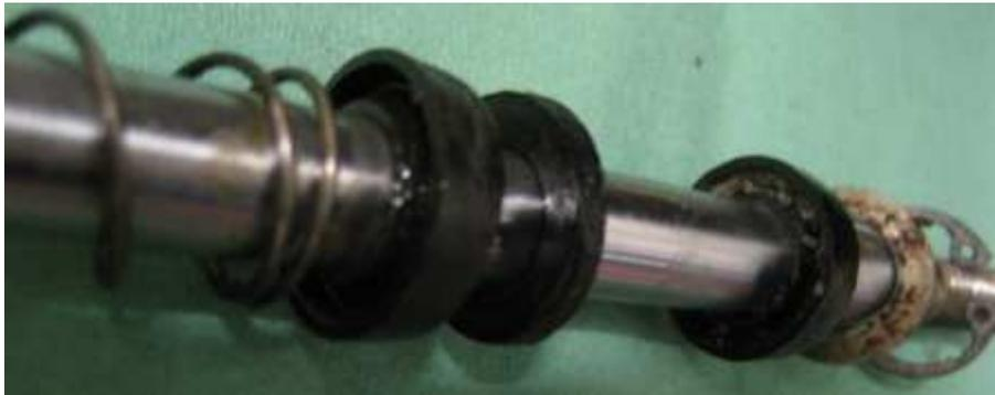
Durchführungsdichtungen im Detail und korrekter Einbaulage
