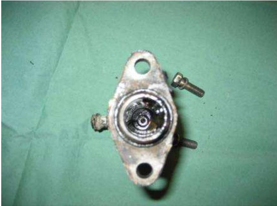
Im Inneren des Zylinders lagern sich gern Schwebestoffe aus der Bremsflüssigkeit und andere Verunreinigungen ab (hier noch verhältnismäßig sauber). Die Flanschdichtung (O-Ring) wird bei der Demontage zwar in der Regel nicht zerstört, zeigt jedoch durch die Aufblühungen in der Grundplatte deutliche Deformationen und Fehlstellen, sodaß diese ersetzt werden muß. Evtl. ist hier auch ein einkleben mit flüssiger Dichtungsmasse möglich.
