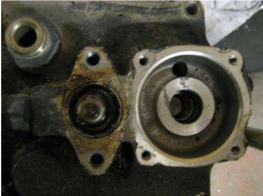
Zu sehen ist die Grundplatte mit Unterdruckanschluß (links), Flansch für den Bremskolben (mitte) und Flansch des Steuerventils/ Belüftungsstutzens (rechts)
