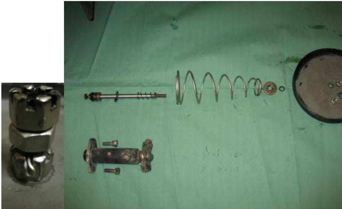
Nach Lösen der Konterung, des Splintes und der Kronmutter kann der Teller des Unterdruckkolbens und die Rückzugsfeder abgenommen werden. Dann lässt sich auch die Kolbenstange des Unterdruckkolbens herausziehen.
