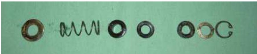
Einzelteile Dichtungen Kolbenstange in Einbaureihenfolge
