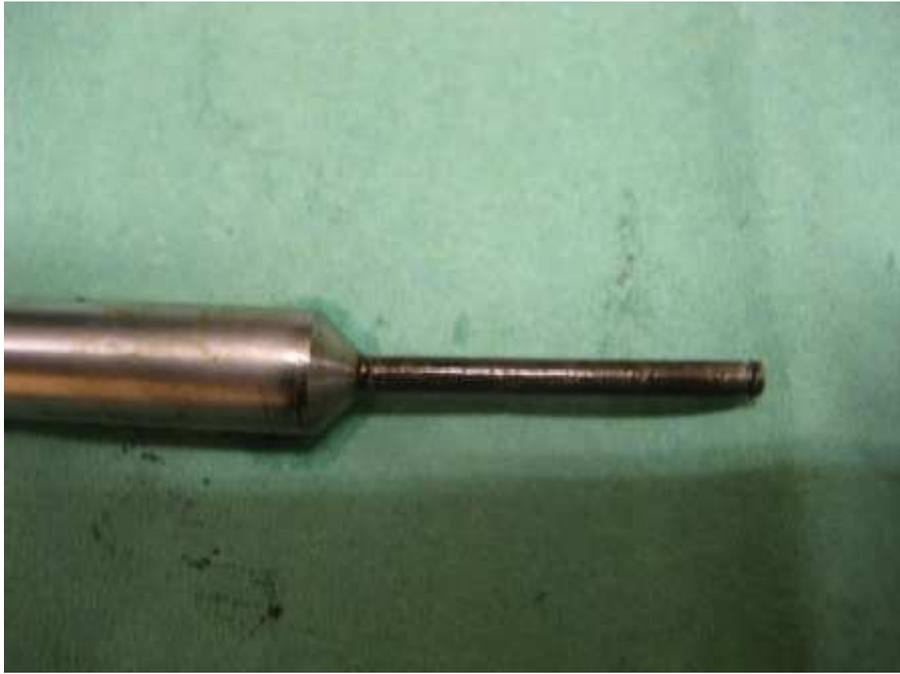
Vorderes Ende der Kolbenstange mit Nut für Sprengring. Hierauf wird der Bremskolben befestigt.
