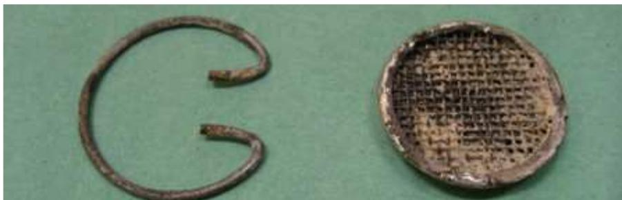
Im Bild, Sprengring und Filtersieb für Belüftungsstutzen
