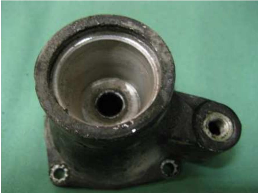
Deckel mit Be-/ Entlüftungsstutzen, sowie der Bohrung für die Verschlußschraube des Unterdruckrohres (rechts). Filtersieb und Rückschlagventil sind hier bereits demontiert.
