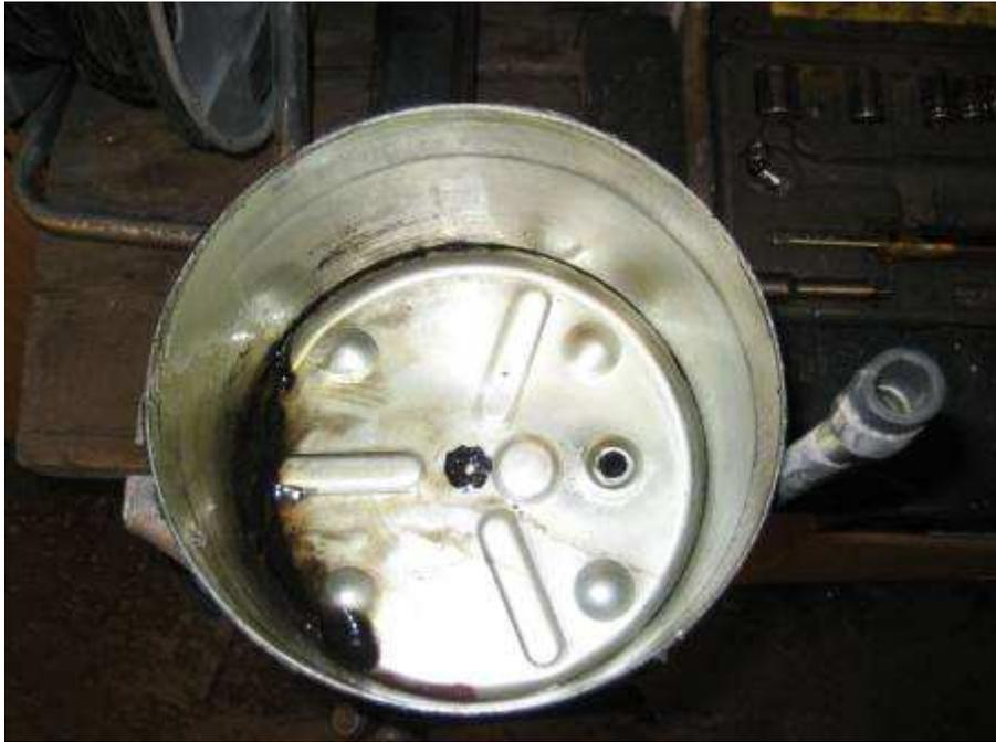
Öffnen des Unterdrucktopfes durch Lösen der vier Spannklammern am Gehäuse. Zum auseinandernehmen den Gußteil am besten einspannen und Unterdrucktopf vorsichtig axial abziehen. Rechts sieht man die Schlauchdichtung des Unterdruckrohres zum Steuerkolben.
