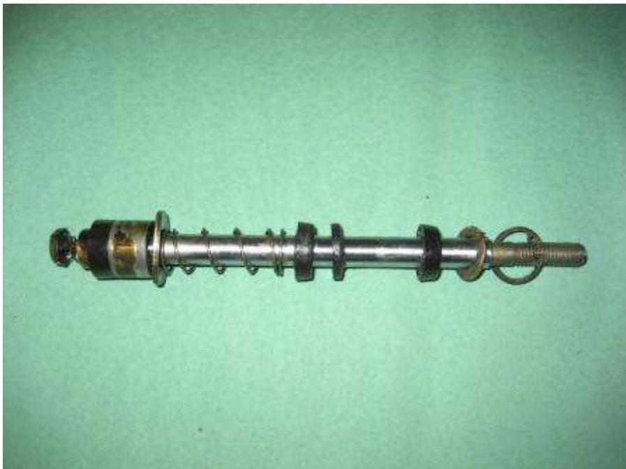
Hier die Kolbenstange mit allen Bauelementen (außer Unterdruckkolben). Zu sehen ist links der Bremskolben mit Nutring, Anschlagring, Druckfeder mit Nutring und Beilagering (Durchführungsdichtung Bremsflüssigkeitsseite), sowie Nutring Scheibe und Sprengring (Durchführungsdichtung Unterdruckseite). Auch hier haben beide Nutringe der Durchführungsdichtung starke Deformierungen und Fehlstellen durch Aufblühungen im Aluminium der Grundplatte.
