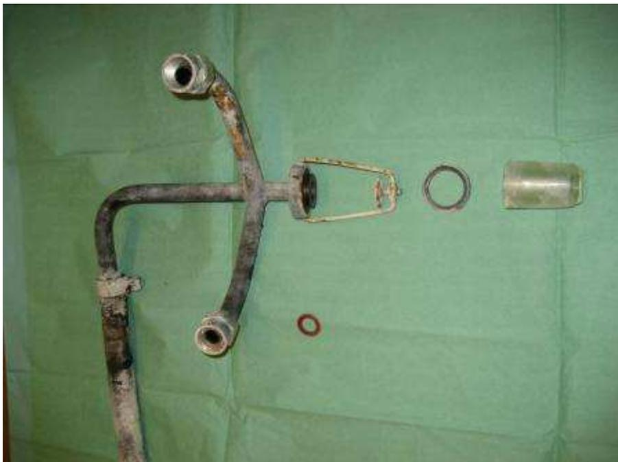
Demontage des Unterdruckrohres mit Schauglas durch lösen der Verschraubung am BKV (Verschraubung mit konischem Klemmkeil und vulkanischer Dichtung [rot])
