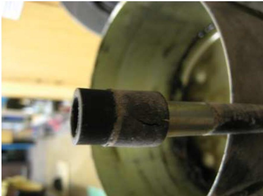
Dichtung des Unterdruckrohres auf der Gußgrundplatte in Form eines Gummischlauches
