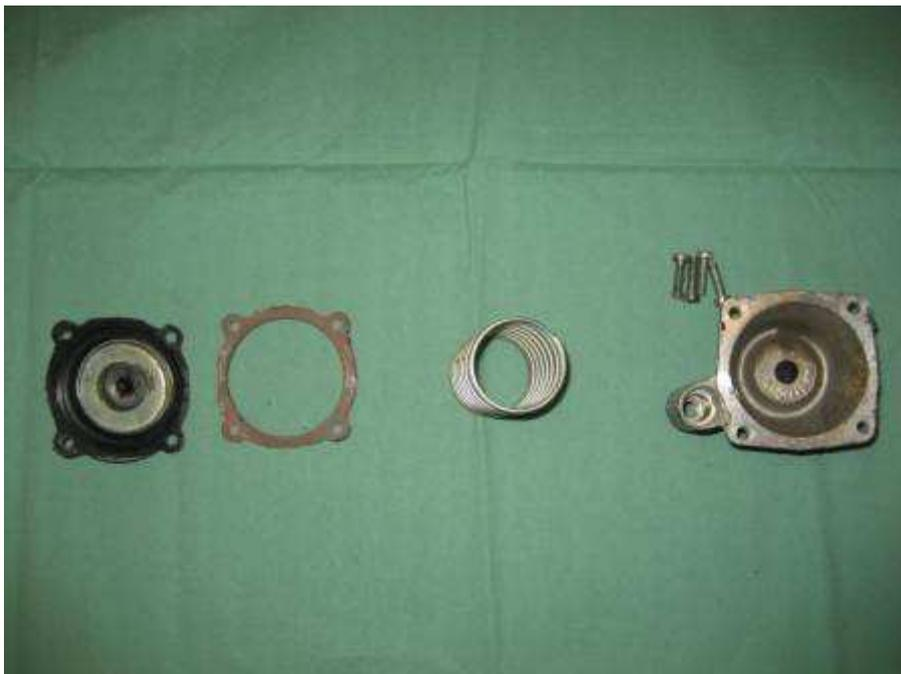
Alle Teile der Reihenfolge nach (wie montiert wird).
