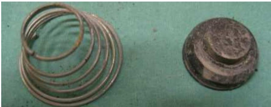
Im Bild, Druckfeder und Gummidichtung des Rückschlagventiles
