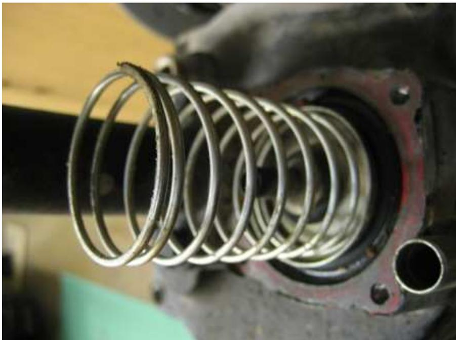
Nach entfernen der vier Schrauben am Entlüftungsdeckel des Steuerkolbens, kann dieser abgenommen werden. Vorsicht! Vorspannung durch Membranfeder. Im Bild ist die Membranfeder zu sehen, die Gummimembran, sowie die vulkanische Dichtung des Entlüftungsdeckels, die in diesem Fall schon ein zweites mal verwendet wurde, was die graue Farbe der ehemals flüssigen Dichtungsmasse verrät.
