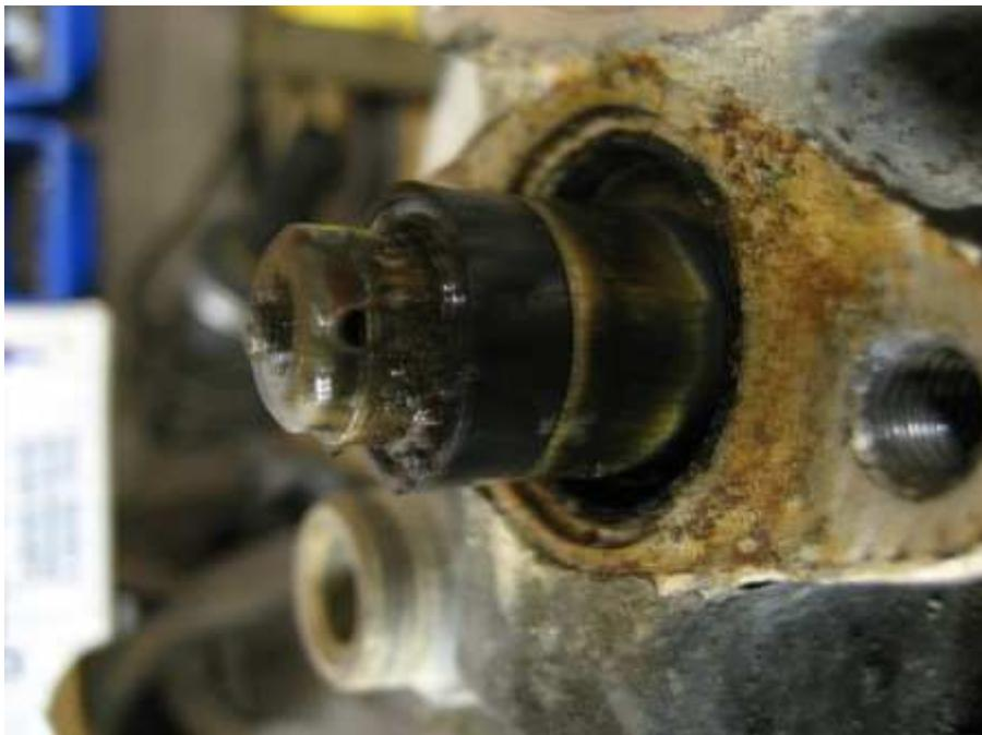
Deutlich sichtbar auch am Gegenstück (Kolben) sind die Ablagerungen. Der Nutring zeigt keine wesentlichen Einlaufspuren und kann ggf. wiederverwendet werden.
