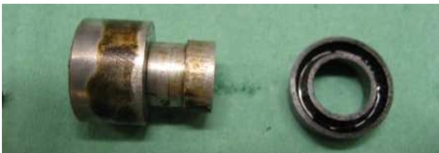
Einzelteile Bremskolben, Kolben und Nutring
