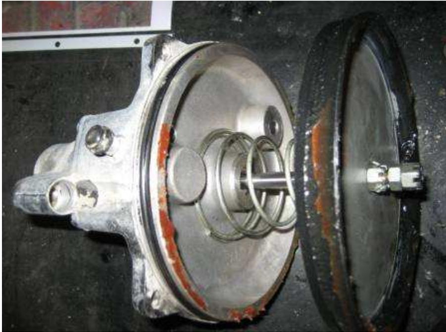
Der Unterdruckkolben ist mit einem speziellen Gleitfett geschmiert. Zu sehen sind hier der O- Ring an der Gußgrundplatte, die Rückzugsfeder des Unterdruckkolbens, sowie dessen Verschraubung
