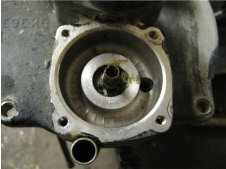
Das Steuerventil sitzt unter der Membran, etwas schlecht zu sehen ist der Sprengling und die geschlitzte Scheibe, die das Ventil fixieren
