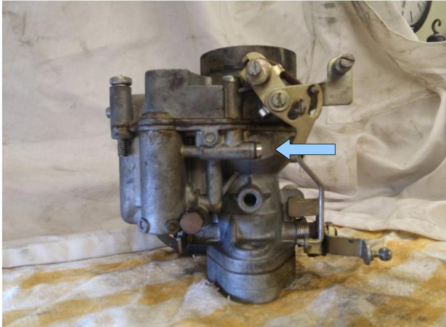
Unterhalb der CHOKE-mechanik befindet sich eine Schlitzschraube . Dahinter befindet sich die Einstellschraube für die Einspritzmenge der Beschleunigungsdüse . Bild 8.12-Teil 20 / 19
