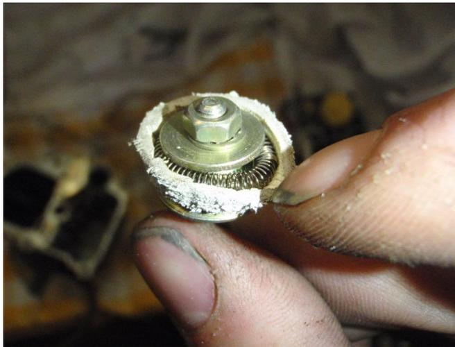
Die linke Feder drückt und zieht die Pumpenmechanik auf und ab. Die rechte Feder sorgt dafür dass es eine gleichbleibend lange Mengenanreicherung gibt. Bleibt die Membran hängen, so wird dies leider auch dadurch nicht bemerkt. Oft reißt dann die linke Feder ab.
